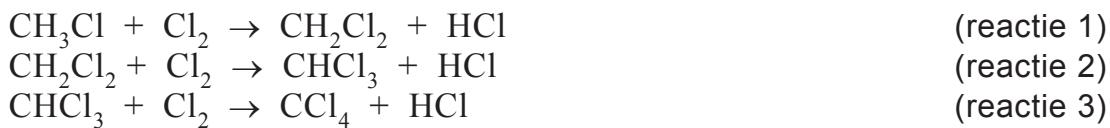
Het gasmengsel dat is ontstaan in ruimte I wordt naar ruimte II geleid. In ruimte II vindt een eerste scheiding plaats. Het overgebleven gasmengsel wordt daarna in ruimte III door middel van destillatie verder gescheiden.
